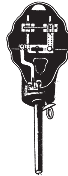
FIG. 93. — Vue intérieure très agrandie (l'électro-moteur étant enlevé) du mécanisme des yeux et de la mâchoire du turco électro-mobile de M. Gustave Trouvé.
